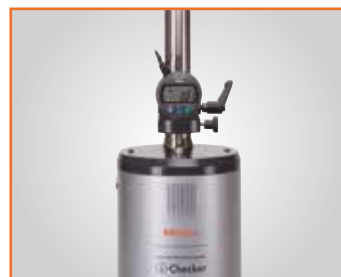
Kalibrace digitálního úchylkoměru
