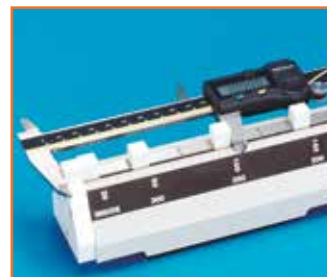
Kontrola přesnosti posuvného měřítka (vnější měření)
