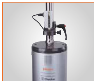
Kontrola lineárního snímače
