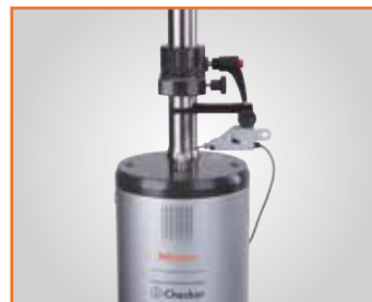
Kontrola páčkové sondy (indukční sondy)
