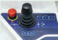
Ovládací panel s joystickem pro rychlé posuvy a tříosé najíždění.
